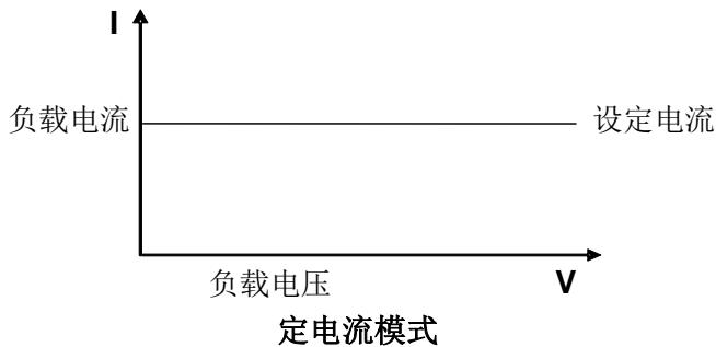
图 3-1 CC 模式电压电流关系图
