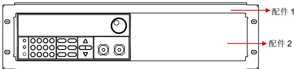
图 1.1 单个仪器上架安装的正视图
