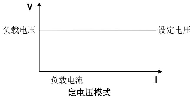
图 3-2 CV 模式电压电流图
