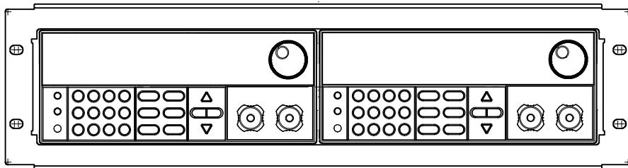
图 1.2 两个仪器并排上架安装的正视图
