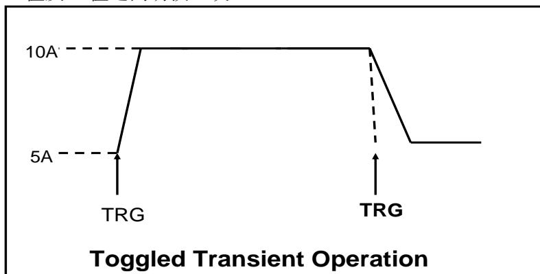
以 CC 模式为例 (其他模式操作类似), 当被测仪器输出电压为 10V, 电流 3A, 负载电流在 1A 和 2A 之间切换, 设置动态测试参数和执行动态测试步骤如下:
